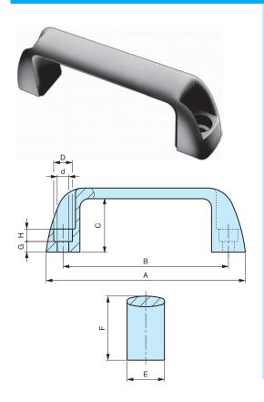
Fixation par vis à tête cylindrique.
